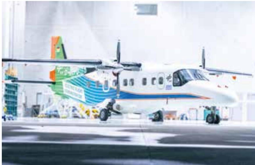
Das neue DLR-Forschungsflugzeug „Do-228“-D-CEFD soll zur Erprobung eines elektrischen von MTU Aero Engines entwickelten 600 kW-Antriebsstrangs eingesetzt werden
