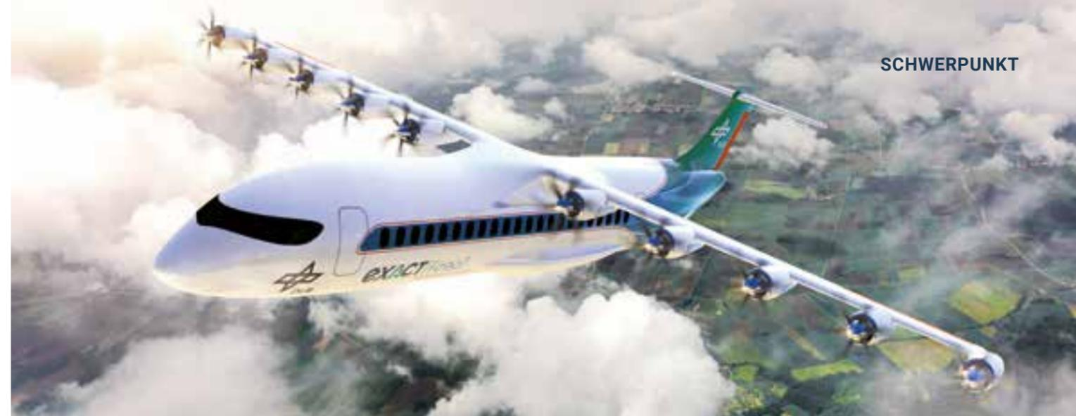
Das Konzept Fuel Cell Electric Regional Aircraft "D70-FC10" mit 10 Brennstoffzellen und Antriebseinheiten in den „Pods“ unter den Flügeln zu sehen, welches für 70 Passagiere ausgelegt ist.
