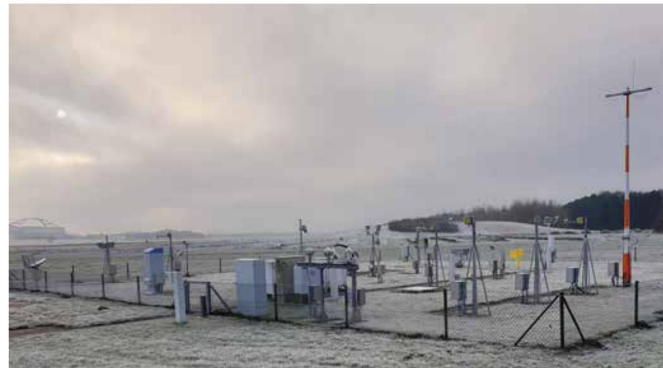
Auf dem Messfeld am Flughafen Hamburg-Fuhlsbüttel sind Niederschlagsmessgeräte, Wetterhütten für Lufttemperatur- und Luftfeuchtemessungen und Luftdrucksensoren für flugmeteorologische Messungen installiert. Darüber hinaus befinden sich hier noch weitere Messinstrumente für andere Messaufgaben wie etwa die Strahlungsmessung
