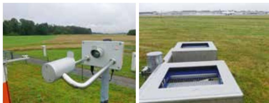
Mit einem Laser-Disdrometer (links) und einem Hageldetektor (rechts) wird lokal am Flughafen die Niederschlagsart bestimmt
