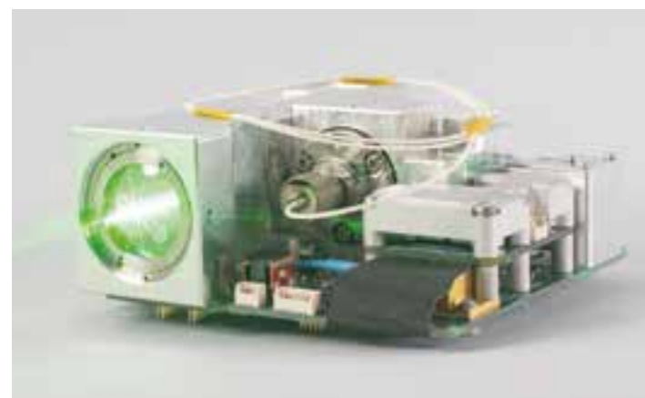
Abb. 1: Laserkommunikationsterminal CubelCT des DLR-Instituts für Kommunikation und Navigation (links) sowie Weiterentwicklung für Inter-Satelliten-Verbindungen CubelSL (rechts)
