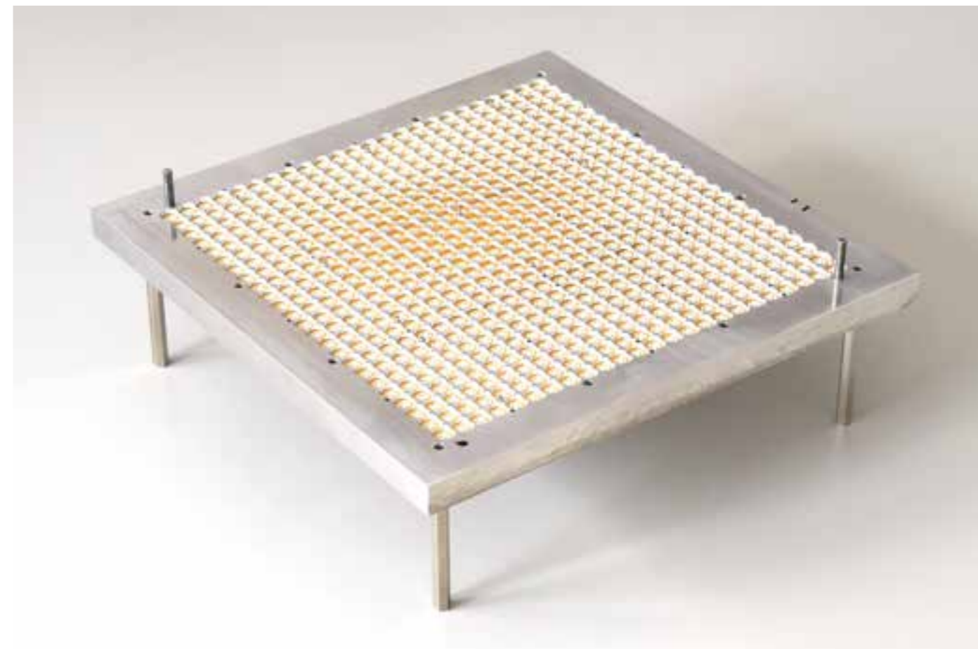
Abb. 2: Planarantenne für 30 GHz mit elektronischer Strahlschwenkung bestehend aus 9 Einzelmodulen mit je 64 Elementen in einem Metallrahmen
