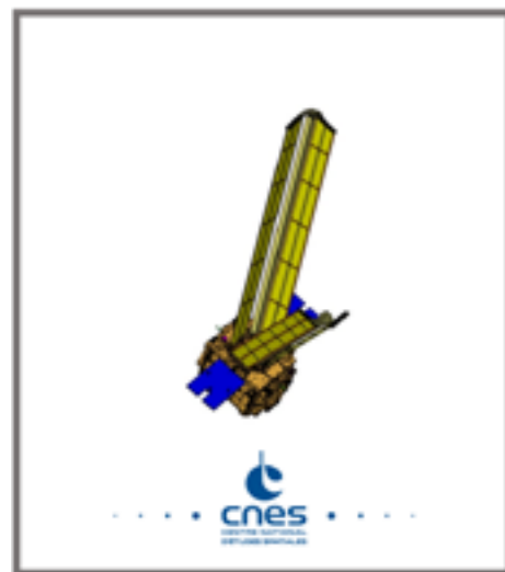
Der Kleinsatellit MicroSCOPE, betrieben von der französischen Raumfahrtagentur CNES, dient der Erforschung der Gravitation. Zu sehen sind eine 3-D-Skizze des Satelliten (links) und eine Radaraufnahme von TIRA (rechts). Die korrekte Entfaltung des De-Orbiting-Systems konnte durch TIRA bestätigt werden
