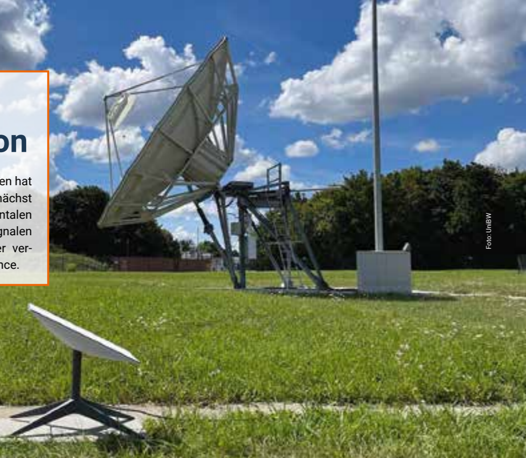
Parabolantenne zur Verbindung mit geostationären Satelliten und ein Starlink-Terminal (im Vordergrund)
