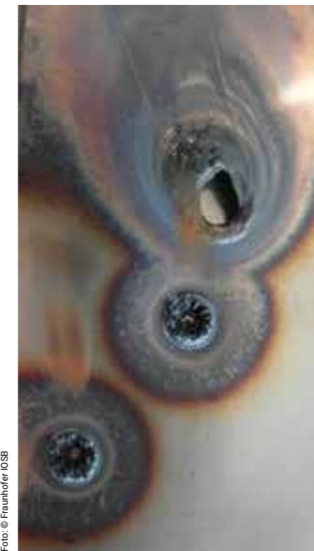
Laserimpakt auf einer Stahlprobe, wie sie beispielsweise für die Abwehr von Granaten untersucht wird
