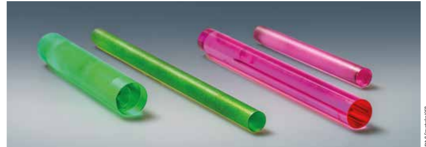
Abb. 2: Typische Laserkristalle für Festkörperlaser, v.l.n.r.: Cr:LiSAF, Cr:Tm:YAG, Rubin, Er:YAG
