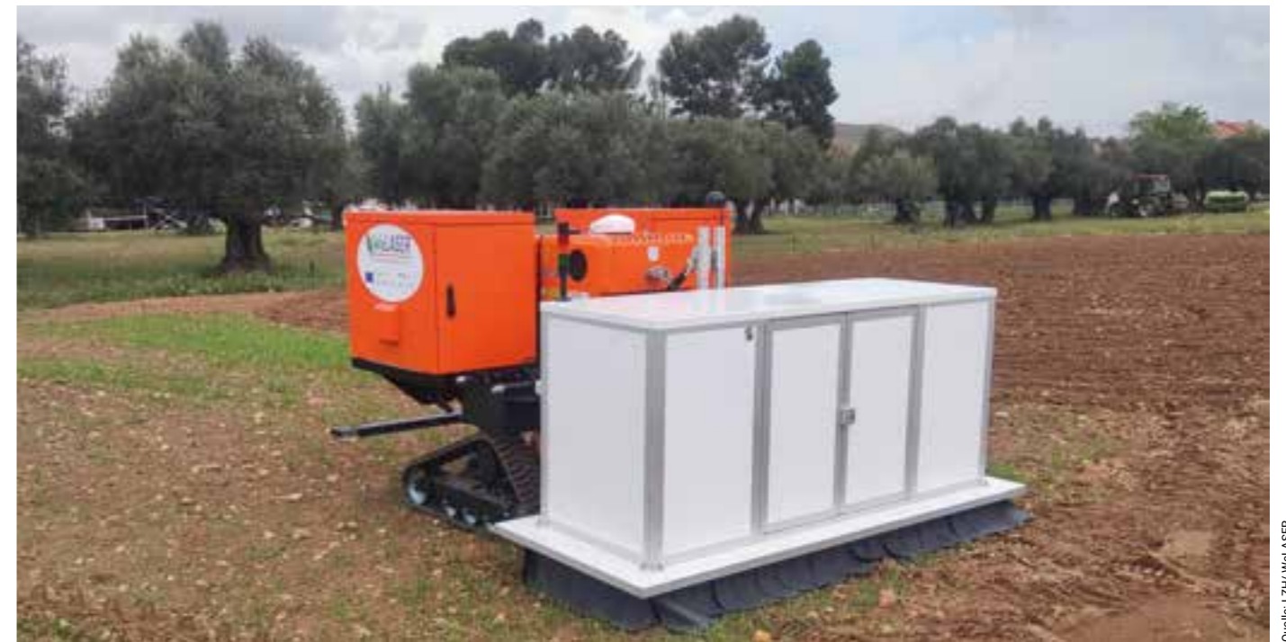
Abb. 2: Autonomer Feldroboter mit Gummikettenlaufwerk und vorgebauter Lasermoduleinheit; Trägerfahrzeug samt Lasereinheit wurde im Rahmen des EU-Projektes „WeLASER“ entwickelt
