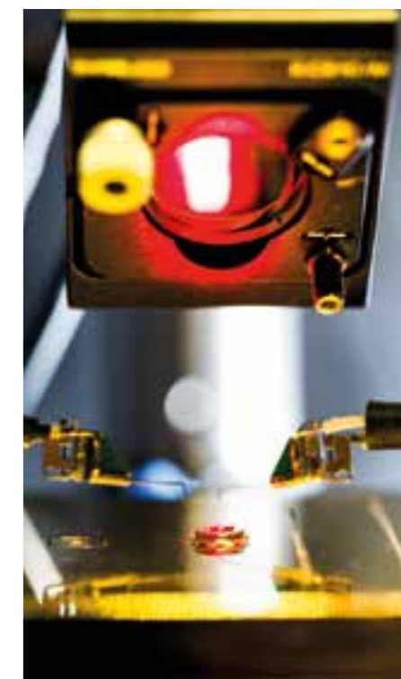
Photonischer Leistungswandler im Messplatz am Fraunhofer ISE
