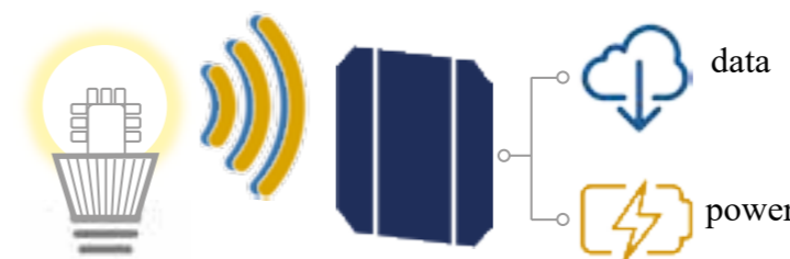
Die Kombination von Kommunikation und Energieübertragung in einer rein optischen Schnittstelle eröffnet neue Anwendungsmöglichkeiten im Telekommunikationsbereich
