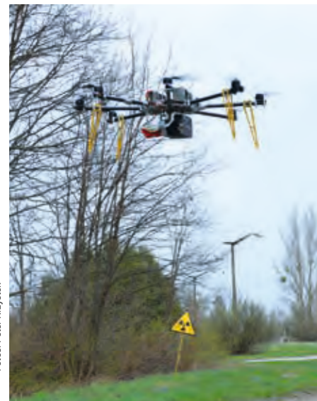
Octocopter mit Laserscanner
