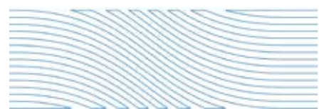
Gedruckter Freiformkörper aus Carbonkurzfaserbeton (oben); Hauptspannungstrajektorien und ein daran orientierter Druckpfad eines balkenförmigen Bauteils
