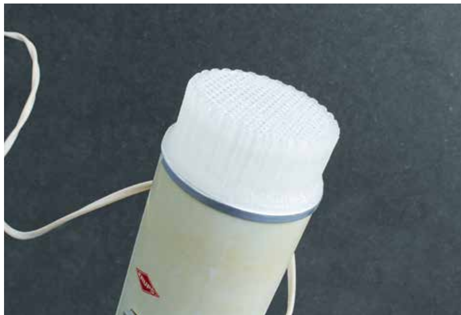
Kaffeemühle mit neu eingepasstem 3D gedrucktem Deckel
