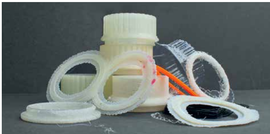
3D gedruckte und tiefgezogene Fehlversuche bei der Herstellung eines Ersatzdeckels für eine Kaffeemühle
