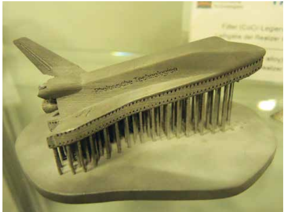
Metalldruck eines Spaceshuttle-Modells mit Stützstrukturen von Florian Huber M.Sc.
