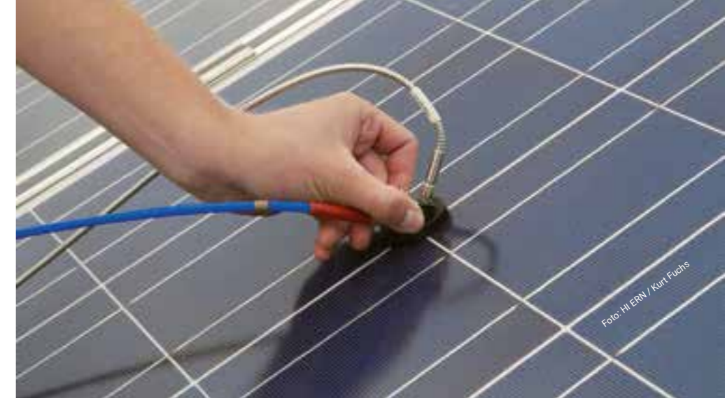
Die Modulflüsterer bei der Arbeit. Hier mit dem „Modul Stethoskop“, mit dem die NIRA Messungen durchgeführt werden
