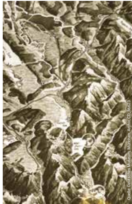
Das Walchenseewerk ist keine Einzelanlage, sondern ein ganzes System aus mehreren Überleitungen, Wehren, kleineren Kraftwerken und einem zehn Kilometer langen Kanal, so dass auch das Isartal bei Bad Tölz betroffen ist
