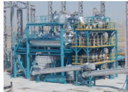
Abb. 1: Vakuumdestillationsanlage in Aserbaidschan zum Recycling von Bohról
