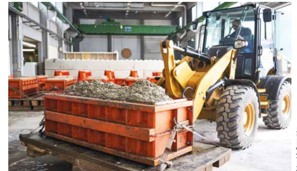
Hundert Prozent rezyklierte Gesteinskörnung im Beton: Probewürfel sollen die Eigenschaften zeigen
