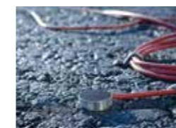
Sensor zur Erfassung des strukturellen Zustandes einer Asphaltdecke.
