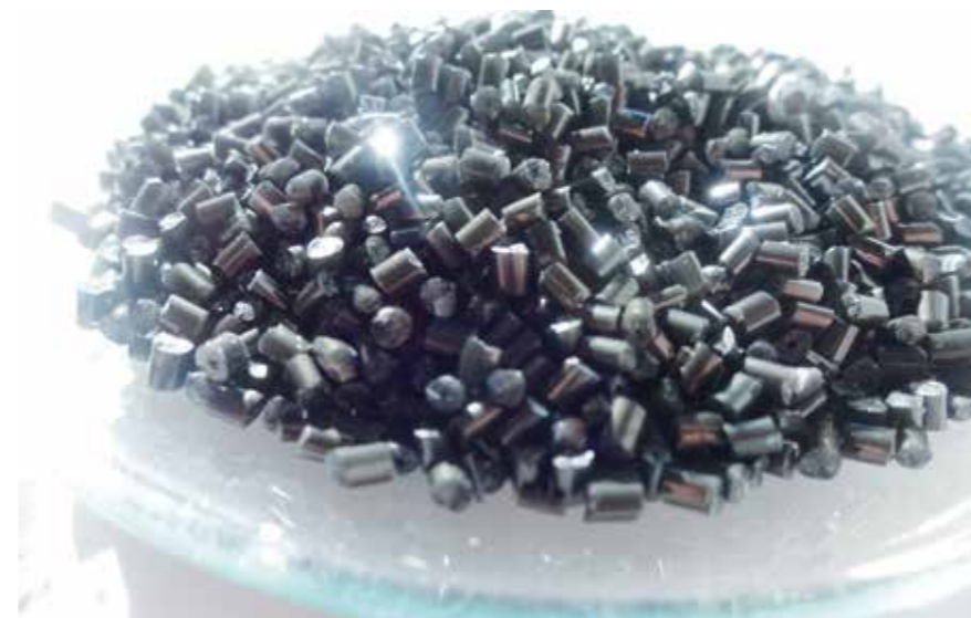
Rezyklate durch den CreaSolv Prozess
