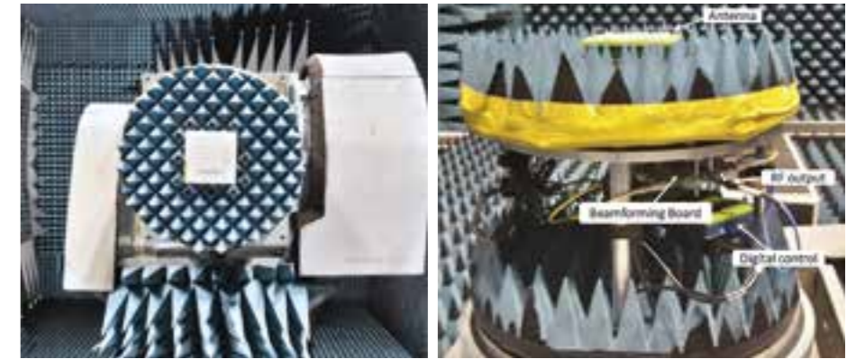
Abb. 2: Prototyp eines Moduls eines aktiven Antennen-Arrays im reflexionsarmen Raum: links: Antenne von oben, rechts: Beamforming-Steuereinheit
