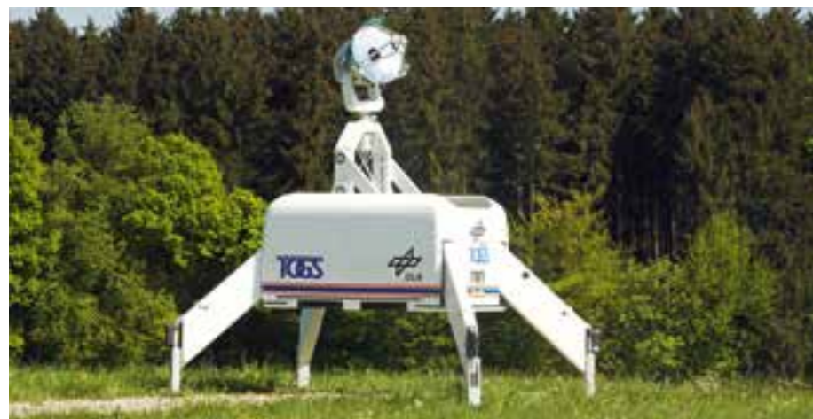
Abb. 2b: Transportable Optische Bodenstation
