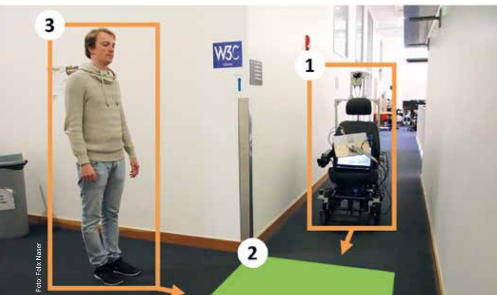
Experiment in einem Gang. (1) Selbstfahrender elektrischer Rollstuhl (2) Region of Interest (ROI) Bereich in dem ein Schattenwurf erwartet wird (3) Dynamisches Objekt das eine Lichtintensitätsänderung im ROI verursacht
