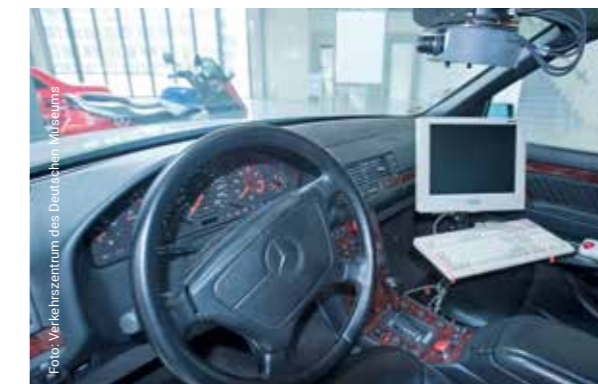
VaMoRs (Versuchsfahrzeug für autonome Mobilität und Rechnersehen) auch Passenger Car (kurz VaMP), entwickelt in den 1990er Jahren von Ernst Dickmanns an der Universität der Bundeswehr München in Kooperation mit Mercedes-Benz auf der Basis eines Mercedes 500 SEL, war eines der ersten autonomen Fahrzeuge. Heute steht es im Verkehrszentrum des Deutschen Museums.
