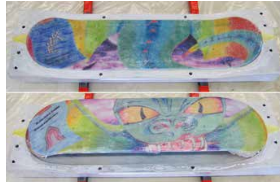
Bild 2: Sandwich-Skateboard mit glasfaserverstärkten Deckschichten, Designmedium und Quarzglasgranulatschicht als Verschleißschutz nach der Entformung [1]
