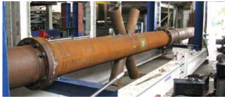
Der großformatige Versuchsaufbau der Hochschule München: Ermüdungstest von Stahlfachwerkbrückenteilen
