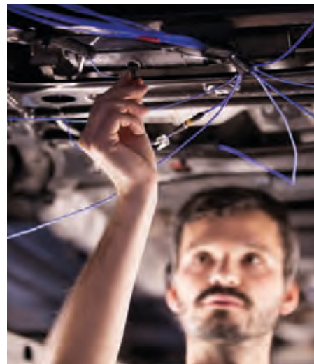
Die Vorderachse des Wagens wird mit Sensoren bestückt, die das Schwingverhalten während der Fahrt aufzeichnen.
